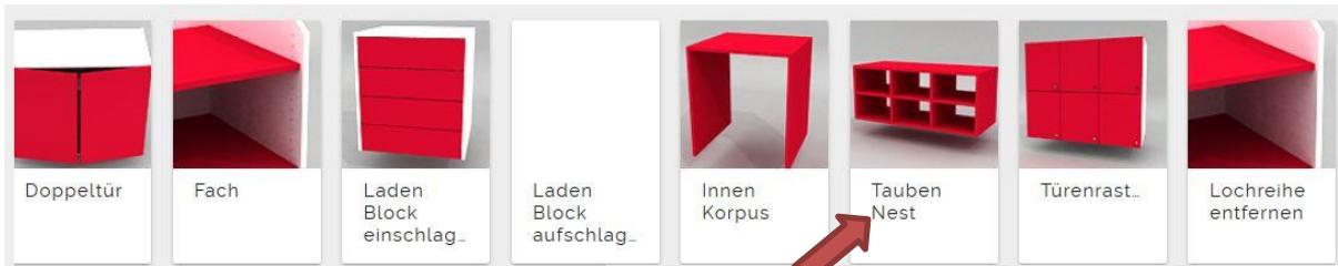
Das Taubennest ist ein Kleingefache (Briefgefache) die wie der Innenkorpus in eine Zone eingefügt werden kann. Einen Bauteil des Taubennestes markieren und es öffnet sich die Eingabeliste an der rechten Seite.
