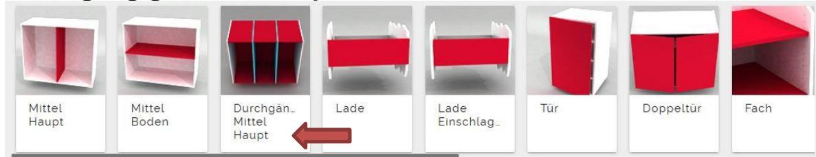
Hier wird das Mittelhaupt mit Boden oben, Boden unten und Rückwand in den Korpus gegeben. Man muss somit beim Grund-Korpus Böden und Rückwand entfernen, ansonsten sind sie doppelt. Mit diesem System kann man den Endlos Schrank bauen, mit bis zu 5 Mittelhäupter (siehe Endlosschrank neu konstruieren). Diese Mittelhäupter werden immer oben und unten bekannt.
